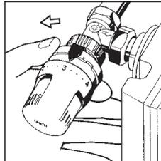
**2.** Gire el mando hasta la nueva posición de máxima apertura deseada (por ejemplo, pos. 3). Gire la virola en sentido antihorario hasta el tope.
