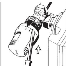
**1.** Utilizando un destornillador, suelte la virola empujándola hacia el cuerpo de la válvula hasta el tope.
