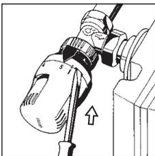
**1.** Gire el mando a la posición completamente abierta (Pos. 5). Utilizando un destornillador, suelte la virola empujándola hacia el cuerpo de la válvula hasta el tope.
