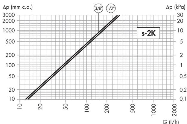
**Válvulas con conexiones invertidas**
