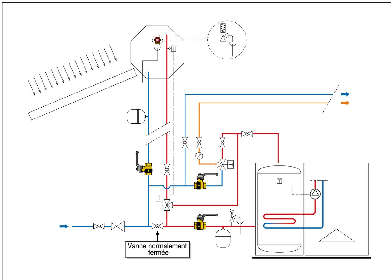
Installation de chauffage avec deux générateurs de chaleur et différents circuits secondaires
