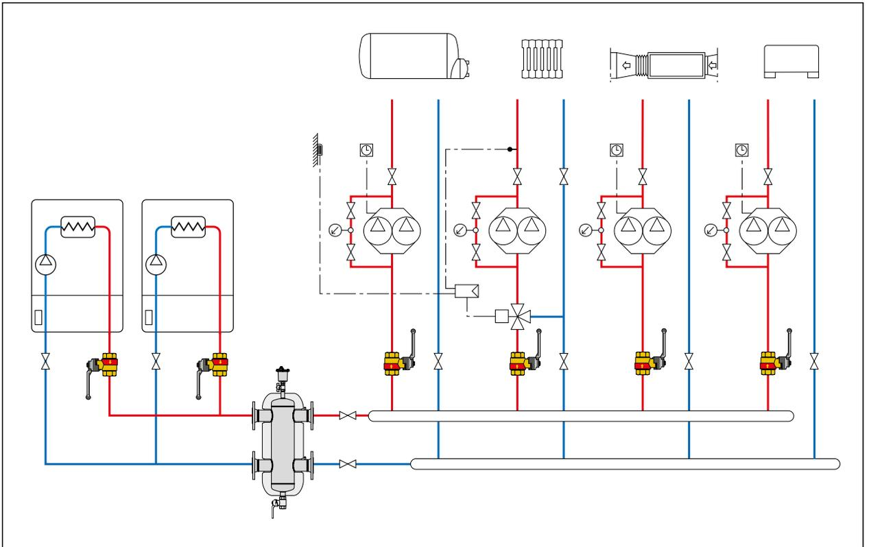
Installation de chauffage avec un générateur de chaleur et différents circuits secondaires
