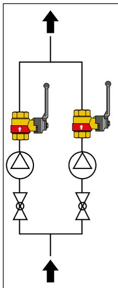
La vanne à sphère, renfermant le dispositif anti-circulation, a, elle, une fonction de vanne d'arrêt : en cas de démontage du circulateur ou de vidange de la chaudière, afin d'éviter de vidanger toute l'installation.
