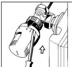
**1.** Поверните ручку в полностью открытое положение (поз. 5). При помощи отвертки отсоедините круглую гайку, толкая ее к корпусу клапана до упора.
