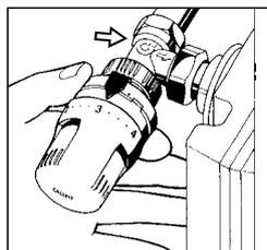
**2.** Установите клапан на нужную температуру и поверните круглую гайку **по часовой стрелке** до упора.
