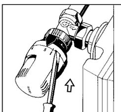
**1.** При помощи отвертки отсоедините круглую гайку, толкая ее к корпусу клапана до упора.
