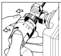
**2.** Поверните ручку в полностью открытое положение, а круглую гайку — **против часовой стрелки** до упора. Стрелки RESET должны совпасть.
