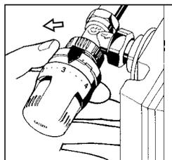
**2.** Поверните ручку в новое положение требуемого максимального открытия (пример поз. 3). Поверните круглую гайку **против часовой стрелки** до упора.
