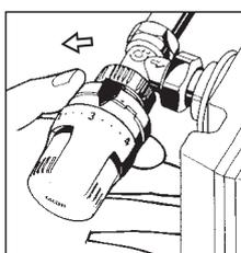
**2.** Gire el mando hasta la nueva posición de máxima apertura deseada (por ejemplo pos. 3). Gire la virola **en sentido antihorario** hasta el tope.
