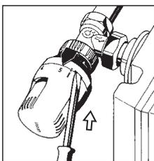
**1.** Utilizando un destornillador, suelte la virola empujándola hacia el cuerpo de la válvula hasta el tope.
