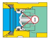
Dans le cas d'une forte contre-pression, l'obturateur (2) déforme le joint (1) et s'appuie sur le rebord en saillie.
