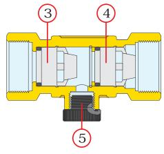
Le double clapets anti-retour peut être utilisé dans des cas relatifs aux normes locales, en alternative au disconnecteur hydraulique, lorsque le réseau de distribution dispose d'une pression réduite.
