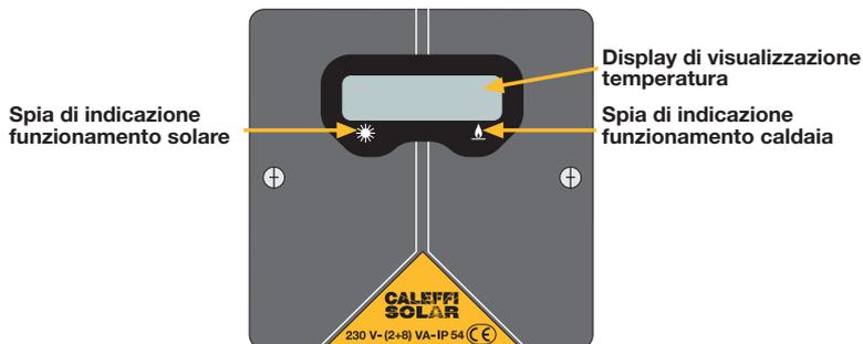
Il termostato, tramite la sonda posizionata sulla mandata dell'acqua calda proveniente dall'accumulo solare, comanda la valvola deviatrice dei kit solari, attivando la caldaia in caso di bassa temperatura dell'acqua proveniente dall'accumulo.
