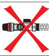
El sistema donde se instale la válvula se debe purgar y limpiar para eliminar toda la suciedad que pueda haberse depositado durante la instalación.
