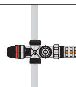
Vidanger le circuit sur lequel la soupape de sécurité thermique doit être installée et le nettoyer pour éliminer les impuretés qui pourraient s'y être accumulées durant l'installation. Il est possible d'installer la soupape en position verticale ou horizontale mais la section de vidange doit toujours être tournée vers le bas. Jamais tête en bas.
