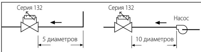
Клапан может устанавливаться в любом положении, с соблюдением направления потока, показанного на корпусе клапана. Он может устанавливаться как на вертикальных, так и на горизонтальных трубопроводах.
