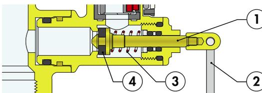
Кольцо включения (2) обладает низкой теплопроводностью, с целью предотвращения ожогов во время открытия измерителя расхода, если через клапан проходит жидкость при высокой температуре.
